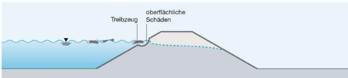
Abbildung 15: Oberflächliche Beschädigung der wasserseitigen Böschung
